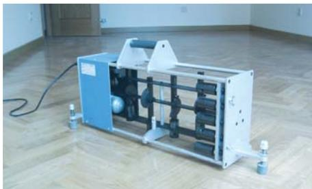
Ensayo: aislamiento acústico a ruido de impacto
