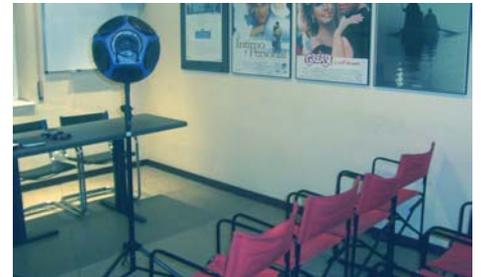
Medición in situ: aislamiento acústico a ruido aéreo
