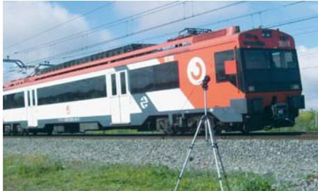
Medición in situ: ruido de tráfico ferroviario
