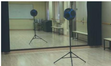
Ensayos: aislamiento acústico a ruido aéreo
